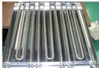
■ W型シーズヒーター3本×3ユニットを取付け、正面側ユニットを引出し可能にしたことでメンテナンス時の作業を容易にしました。
