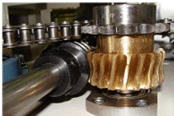
■ はんだ槽電動上下引出しウォーム機構方式を採用しスムーズな操作性・メンテナンス性の向上
